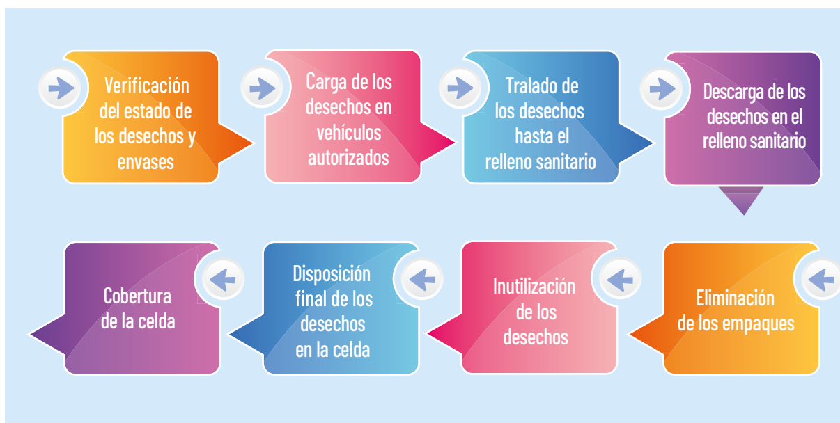
Diagrama 2. Procedimiento para la disposición final de los desechos especiales no peligrosos en rellenos sanitarios Elaboración: STAND/UNODC
